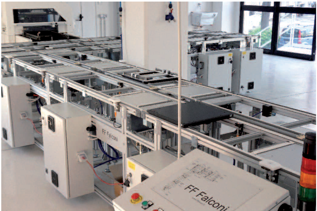
▼ Fig. 3 Stazione di remanufacturing schede
