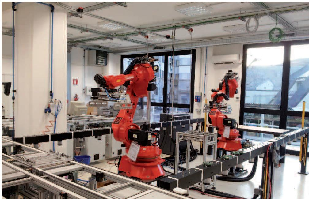
▲ Fig. 2 Robot cooperanti per il macro-disassemblaggio
